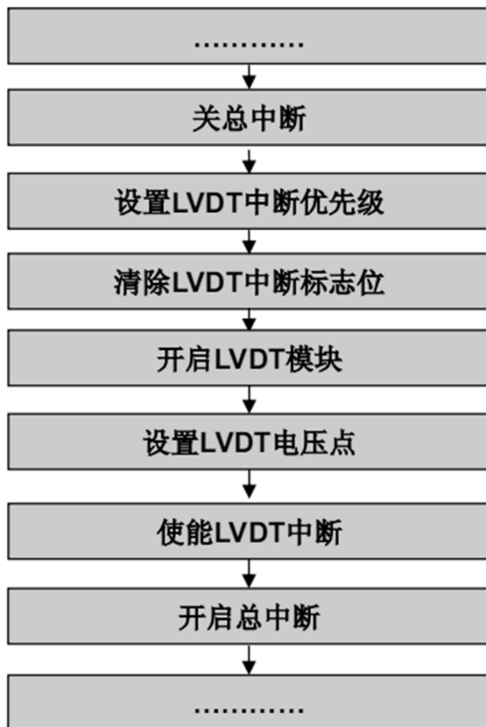
LVDT 低电压检测配置流程
